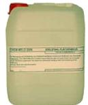
Edelstahlflächenbeize zur Reinigung und zur Aufhellung von Edelstahloberflächen sowie zum Entfernen von Fremdrost. Chem-Weld 2606 wird unverdünnt durch Wischen, mit dem Pinsel oder Schwamm auf die Oberfläche aufgebracht. Empfohlene Einwirkzeit: je nach Verschmutzung 20 - 30 Minuten. Anschließend mit Wasser abwaschen. Beize darf nicht eintrocknen! Enthält: Salpetersäure, Phosphorsäure, Flusssäure. GIFTBEZUGSLIZENZPFLICHTIG.
